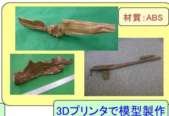
本研究では鉱山坑道内部を非接触で測定できる遠隔操作型ロボットを開発した。ロボットには3次元レーザスキャナやカメラが搭載されている。3次元レーザスキャナは、短時間で複雑な環境や地形の詳細な3次元イメージを作成するレーザ技術を使用している。この結果から坑道内での金銀の採掘体積を算出することができる。更に、鉱物の産出量も推定可能となる。また得られたデータを基に3Dプリンタを利用して採掘時の坑道の形を再現できる。坑道周辺地形の3次元点群データと複数の坑道内3次元点群データをパソコン上で重ね合わせることによって地中内での坑道間の相互関係を推測することも可能である。
